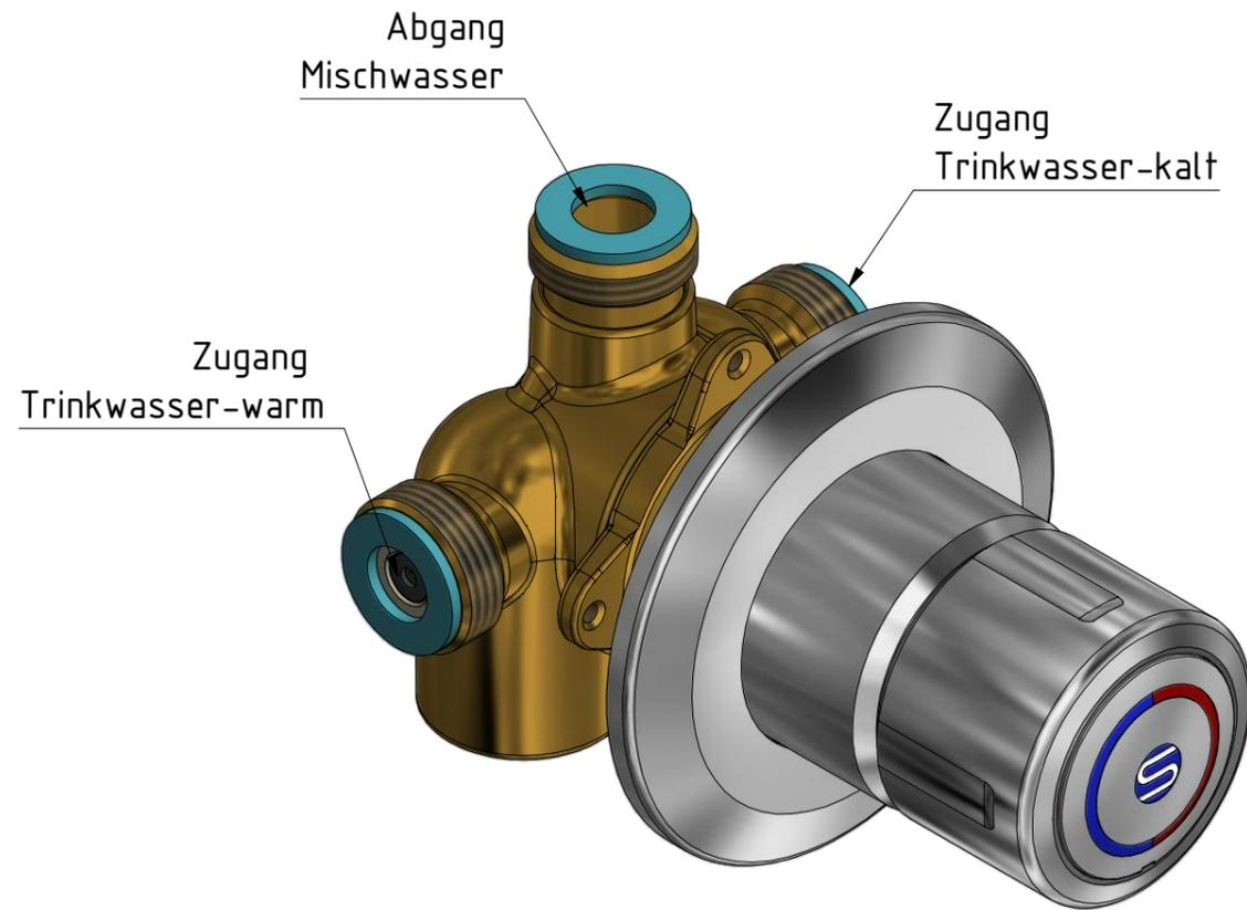
Selbstschluß-Brausemischbatterie zum Einbau in ein Unterputzgehäuse
